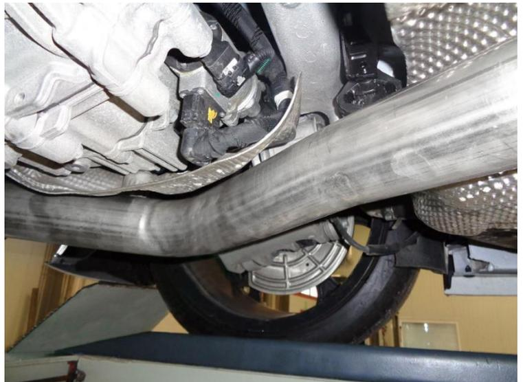
Den REMUS Sportschalldämpfer auf die Verbindungsrohre aufschieben und die Gummiaufhängungen an den Befestigungspunkten der Karosserie einhängen. Die REMUS Endrohrbögen auf den REMUS Sportschalldämpfer aufschieben.
