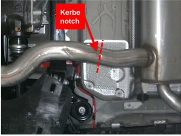
Den Aktuator von der Halterung des Schalldämpfer demontieren. Die Aufhängungsgummis aushängen und den serienmäßigen Endschalldämpfer abnehmen.
