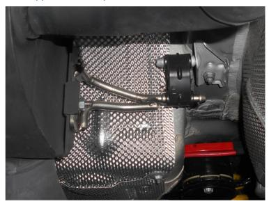
Den REMUS Sportschalldämpfer am Serienrohr montieren und die Gummiaufhängungen an den Befestigungspunkten der Karosserie einhängen. Die REMUS Endrohrbögen am REMUS Sportschalldämpfer montieren. Den Aktuator der serienmäßigen Klappensteuerung an der dafür vorgesehenen Halterung am Sportschalldämpfer montieren und das Aktuatorkabel anschließen.
