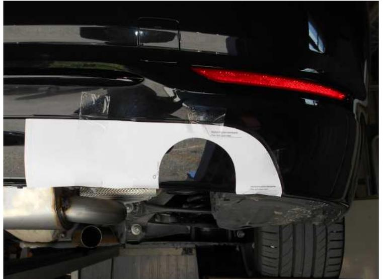
Den REMUS Sportschalldämpfer, mit Hilfe des mitgelieferten Adapters, am Serienrohr montieren und die Gummiaufhängungen an den Befestigungspunkten der Karosserie einhängen.
