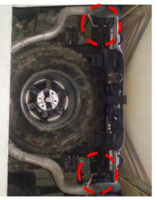
Die Flansch- und Schellenverbindungen der Schalldämpfer lösen, die Aufhängungsgummis aushängen und die Serienschalldämpfer abnehmen.
