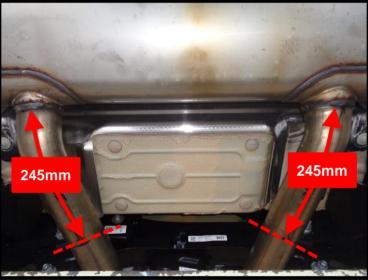
Die Aufhängungsgummis aushängen, den Aktuator abschließen und den serienmäßigen Endschalldämpfer abnehmen.
